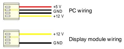
Figure 2-5 Wiring for 12 volt modules
