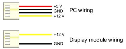
Figure 2-5 Wiring for 12 volt modules
