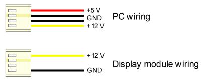
Figure 2-5 Wiring for 12 volt modules
